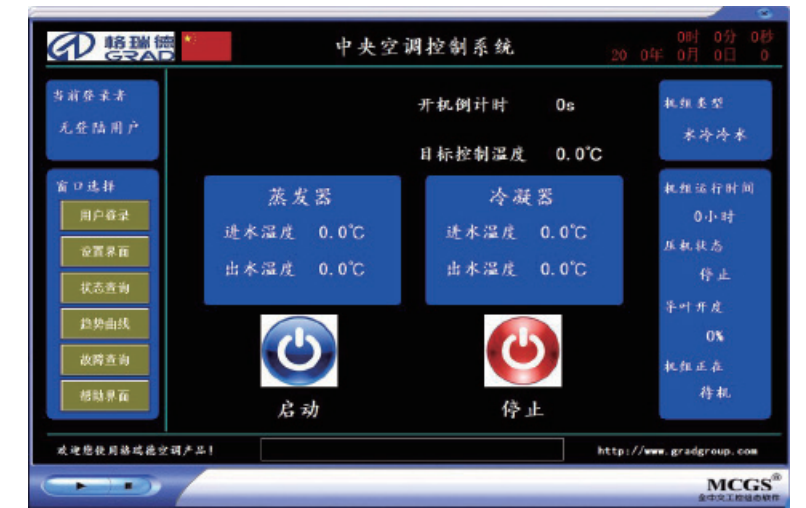
中央空调控制中心界面
